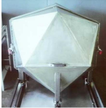
Der "Sputnik" genannte Icosaeder, in dessen Innerem die Strahlung radioaktiven Materials zumindest teilweise neutralisiert wird.
