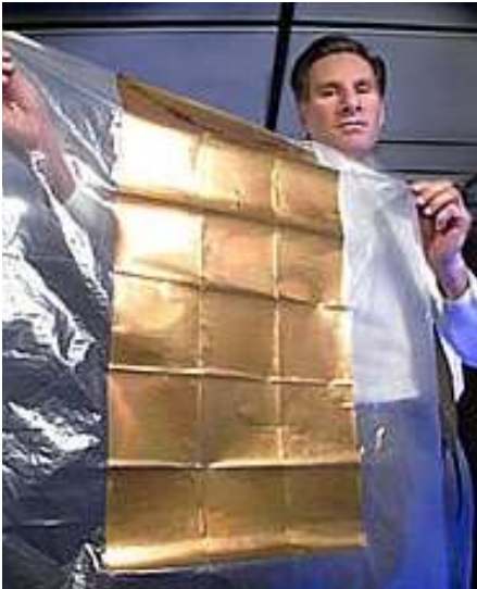
Spezielle Solarfolie, die infrarotes Licht, also Wärmestrahlung, direkt in Strom umsetzen kann.
