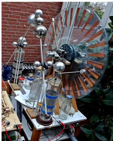
Versuchter Nachbau einer Testatika anhand einer Wimshurst-Maschine.
