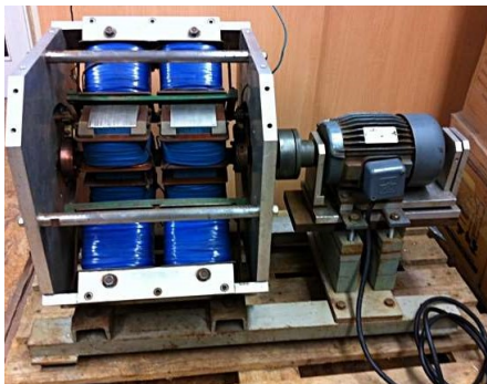
Der durch die DVR nachgebaute Kromrey-Generator.
