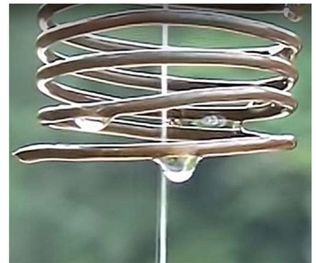
Der Wasserstrahl fließt hier senkrecht. Wird der Strom durch Berührung der Metalldeckel mit der Hand abgeleitet spritzt der Wasserstrahl ungeordnet gegen alle Seiten.
