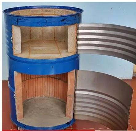
Innenansicht nach dem Einsatz einer Platte und dem Verlegen von Back- und Schamottsteinen.
