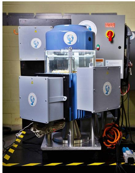
Der 10- bis 15-kW-ILPG (In-Line Power Generator) der Firma Holcomb mit einem COP von 4:1.
