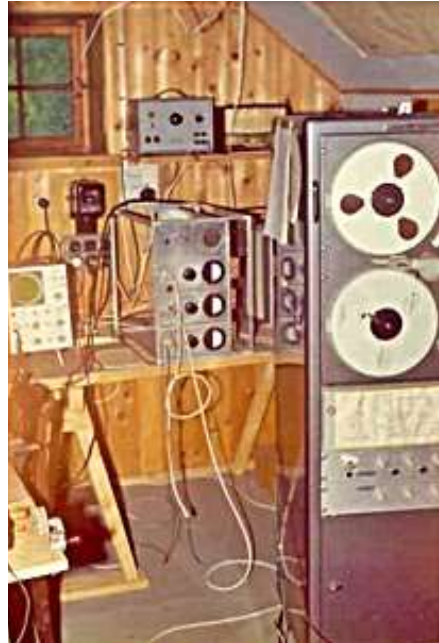
Figur 1: Im bäuerlichen Brannenburger "Dachkammerl" das Elektronik-Labor meines Vaters, um mittels röhrenbestückter Analog-Filter und synchronisierter Tonbandaufzeichnungen Gewitter-Blitze und Spherics über 3 Meter große Spulen und 15 Meter hohe Antennen im eigenen Grundstück mit den Messstationen in München sowie in den USA synchronisiert zu erfassen. Mehr im Buch "Unsichtbare Umwelt" (H. I. König, 2012).
