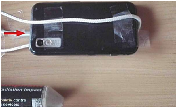
Figur 7: Es wird eine kabelgebundene Verbindung zwischen dem mehrkanaligen Umhänge-SHLS, Prototyp) direkt und dem Kopfhöreranschluss eines 4G/LTE-tauglichen Smartphones gezeigt.
