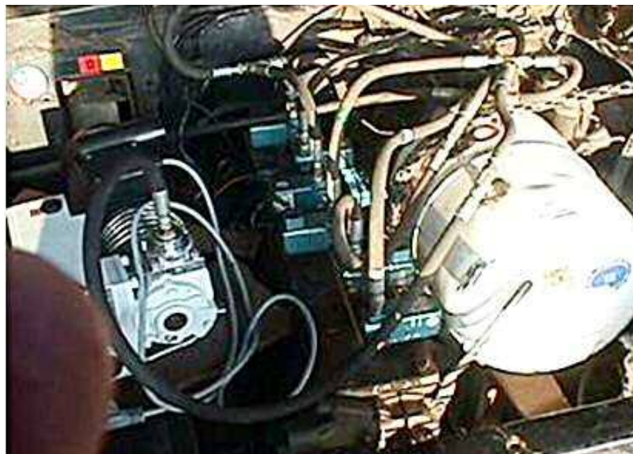
Der umgebaute Chevy-Motor mit den deutlich über den Zylindern erkennbaren elektronisch gesteuerten Ventilen. Links: Vakuumpumpe. Rechts: Vakuumentank.
