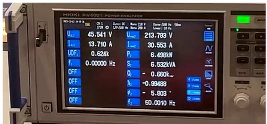
Display des HIOKI-Leistungsanalysators am Ende des ausgewählten Messzeitraums bei 8 Minuten und 20,52 Sekunden, an Filmposition 6:21/6:22.
