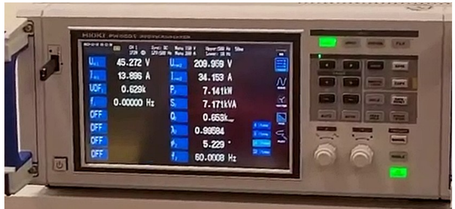
Display des HIOKI-Leistungsanalysators zu Beginn des ausgewählten Messzeitraums bei 2 Minuten und 8,22 Sekunden an Filmposition 0:08/6:22.
